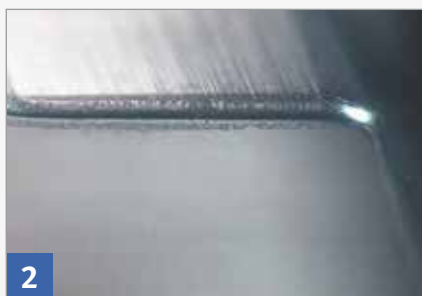
Physikalischer Verschleiß bei einer Stahlschneide
