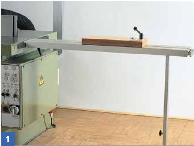
Tischverlängerung mit verstellbarem Queranschlag
