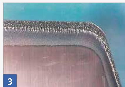
Chemischer Verschleiß bei einer Hartmetallschneide durch Holzinhaltstoffe
