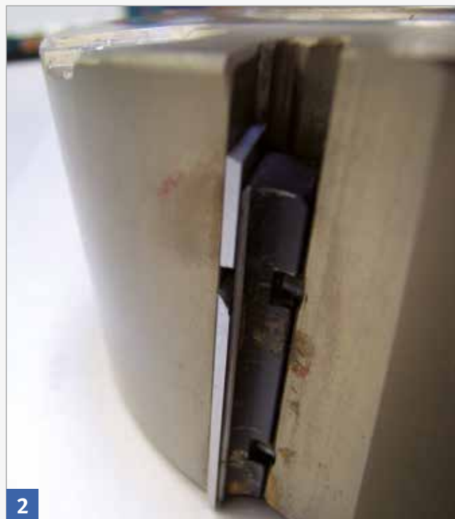
Durch Überlastung des Werkzeugs gebrochene Hartmetallschneide
