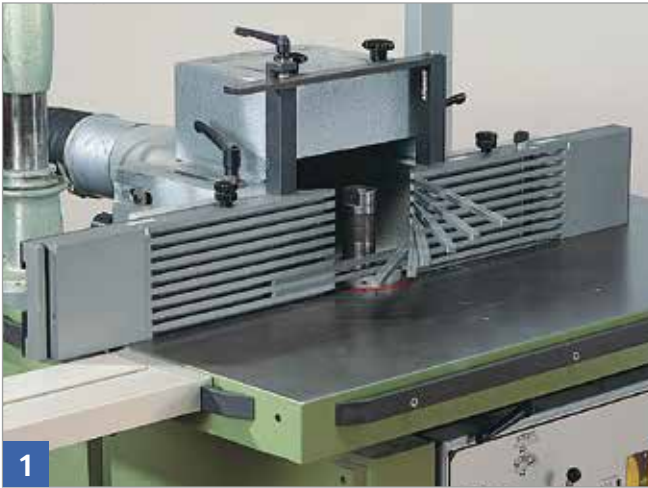
1 Anschlag mit schwenkbaren Überbrückungsstegen
