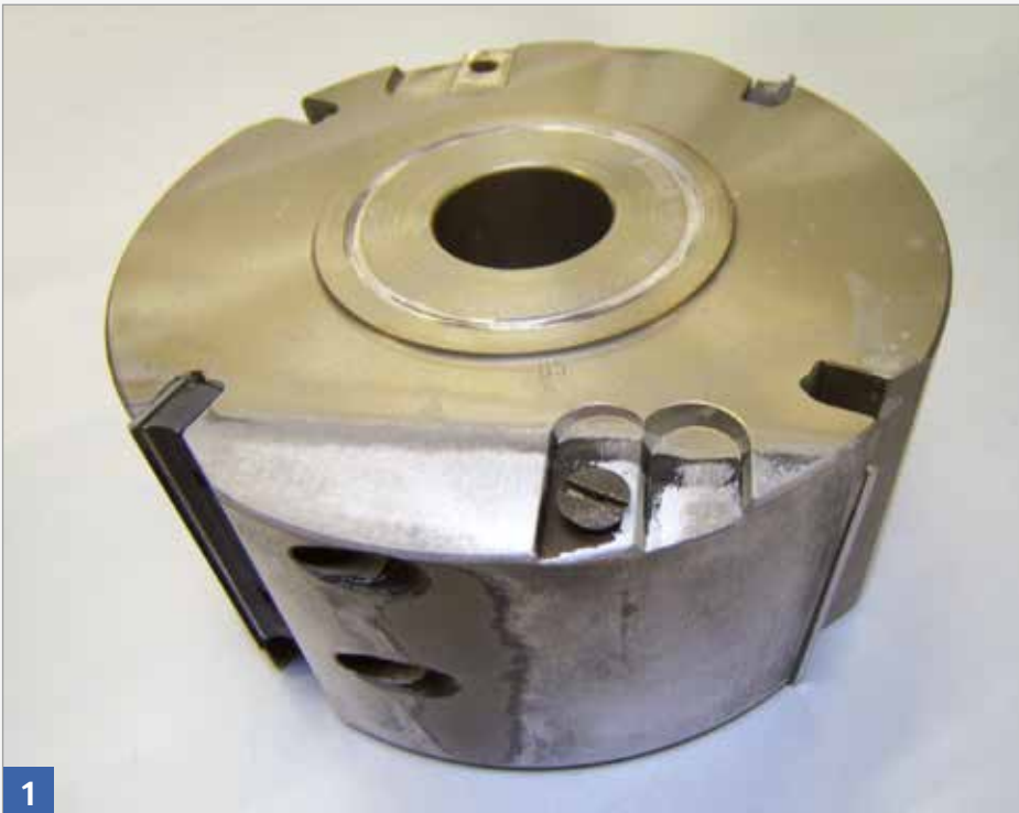
Durch Kaliumhydroxid angegriffenes Aluminiumwerkzeug
