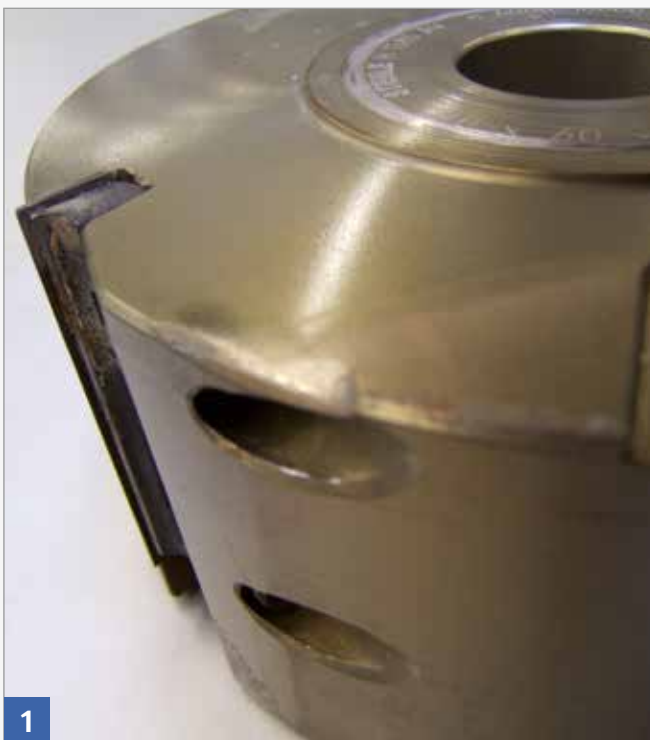
Durch Werkzeugsturz deformierter Aluminiumtragkörper
