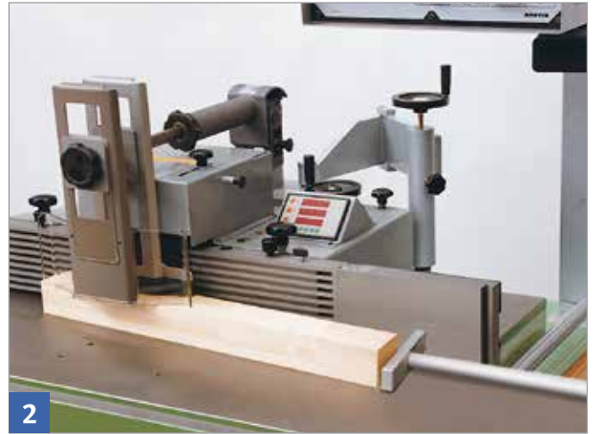
Rückschlagsicherung für Tischfräsmaschinen mit überlangem Tisch
