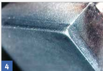
Thermischer Verschleiß bei einer Hartmetallschneide durch zu hohe Schnittgeschwindigkeiten
